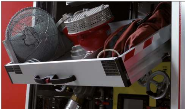
Die LDR Kippschublade wurde mit stabilen F-Führungsschienen und großzügig abgerundeten Ecken ausgestattet.
